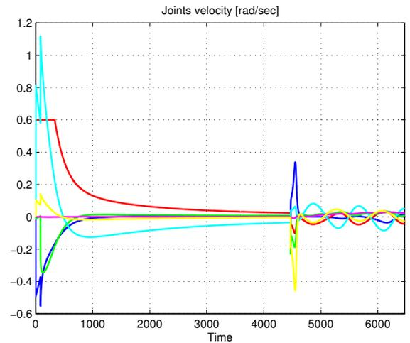
Fig. 11. *Scenario Simulation Results: Joint's velocities, blue -  $q_1$ , red -  $q_2$ , green -  $q_3$ , cyan -  $q_4$ , magenta -  $q_5$ , yellow -  $q_6$ , black -  $q_7$ .*
